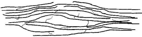
图 4-1 苧麻纤维大分子链间交联示意图
