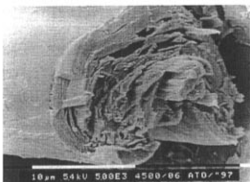
图 2-2 亚麻纤维断面微观示意图
