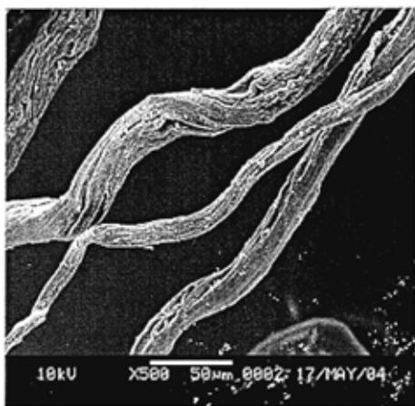
图 6-5 改性后亚麻纵向结构电镜图
