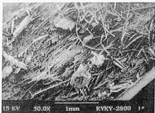
图 28 未漂麻/不饱和树脂板材横向拉伸断口形貌
