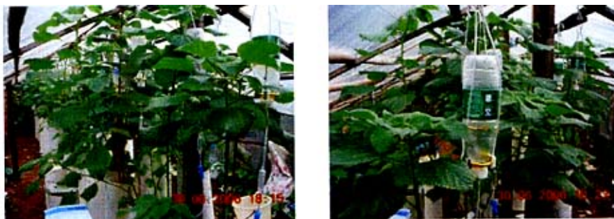
图 7-3 土柱试验中淋溶液收集和植物的根部生长
