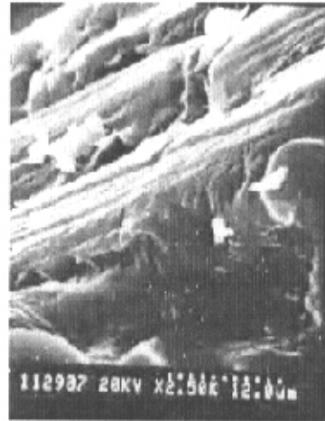
图 3—9 (9) 无缺口冲击破坏断口的 SEM 照片 图 3—9 (10) 无缺口冲击破坏断口的 SEM 照片
