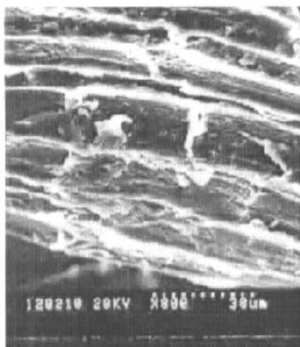
图 4—6 (c) SF 7 /PP 复合材料无缺口冲击破坏断口的 SEM 照片 (SF=10mm, W pp =50%)
