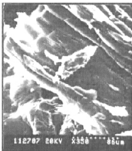
图 3-3 (b) SF/PP 复合材料无缺口冲击破坏断口的 SEM 照片 ( W_{pp}=50\% SF=20mm )
