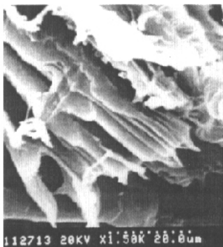
图 3—5 SF/PP 复合材料无缺口冲击破坏断口的 SEM 照片 (SF=20mm, W_{pp}=30\% )
